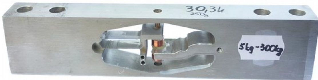
Rys. 9 Specjalna belka pomiarowa dla wag II klasy o zakresie pomiarowym 5kg do 300kg
