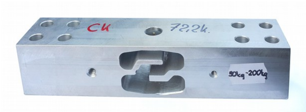
Rys.3 Belka pomiarowa o zmiennym przekroju sprężyn pomiarowych
